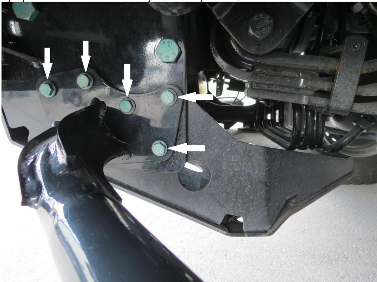
3. Прикрепить щит к кронштейнам при помощи болтов М14х40 с самоконтрящимися гайками М14 и шайбами 14.
