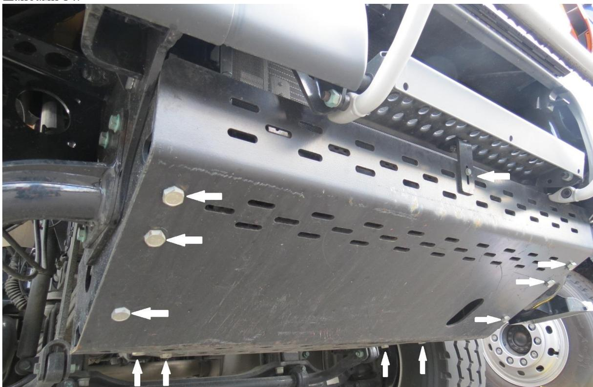
4. Прикрепить ступеньку к щиту при помощи кронштейна, штатного крепежа и болта М6х30 с шайбой и гр. шайбой 6.
