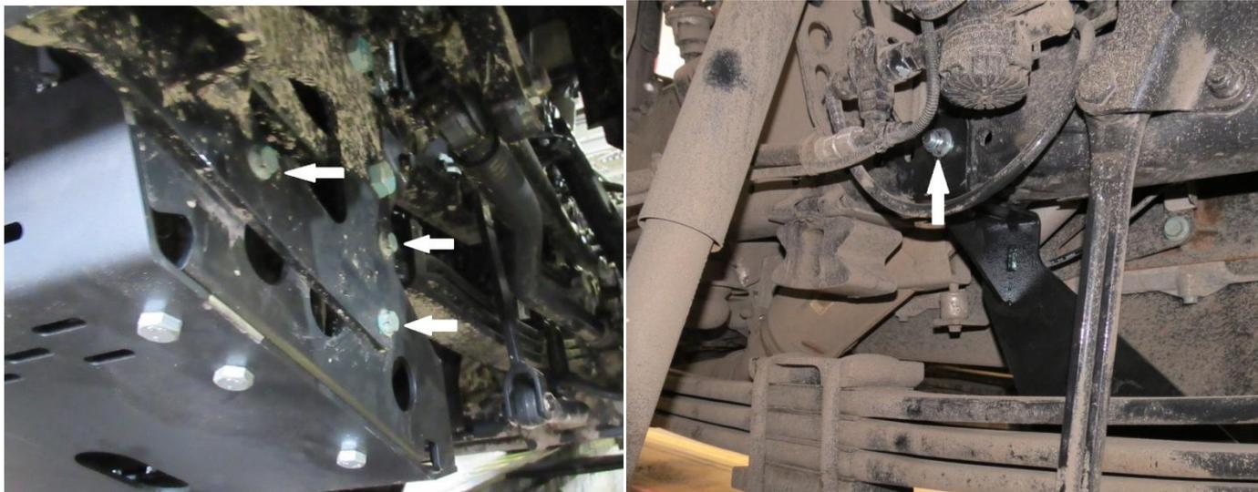
4. Прикрепить щит к кронштейнам при помощи болтов М14х40 с самоконтрящимися гайками М14 и шайбами 14. Из комплекта крепежа
