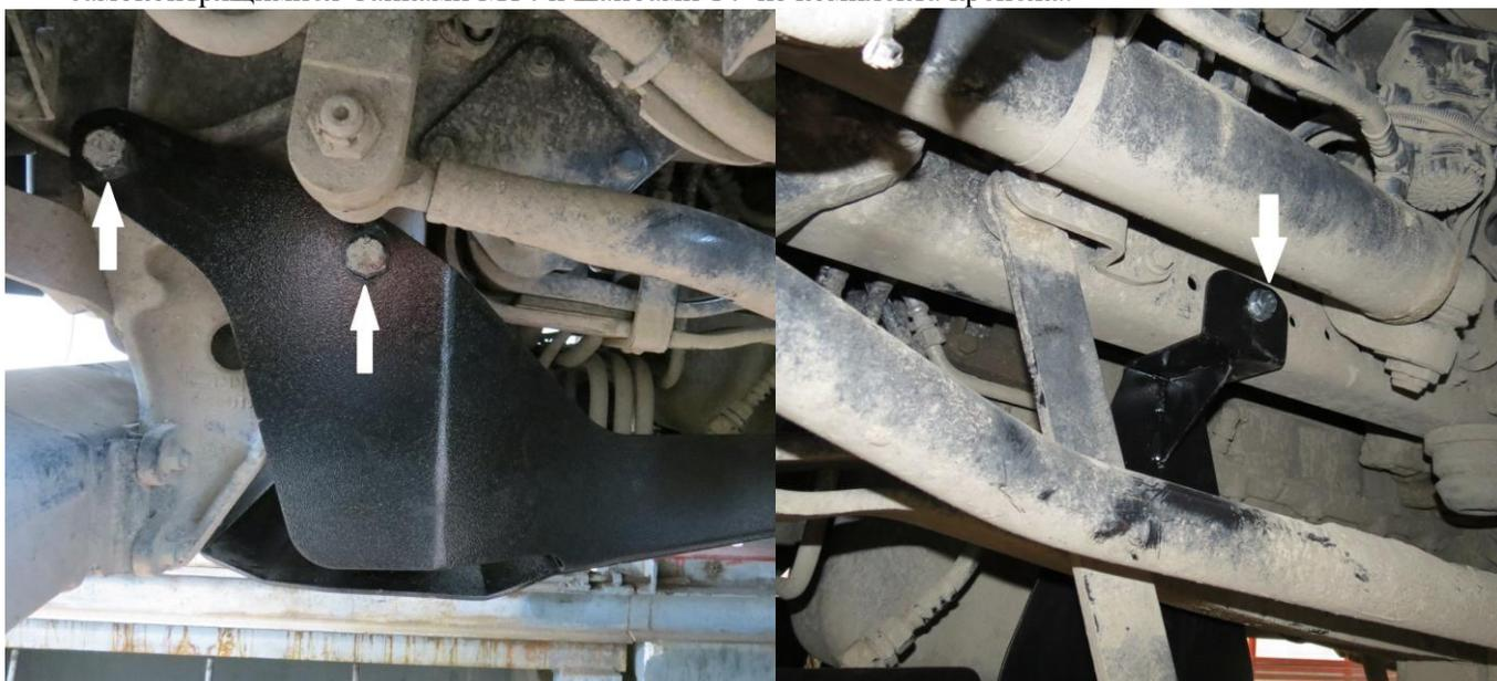
3. Прикрепить переднюю часть щита под штатные гайки крепления противоподкатного бруса.
