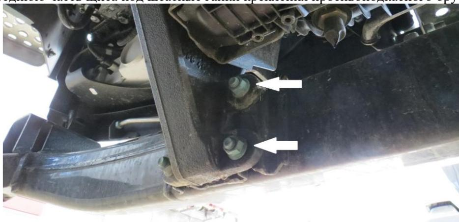
4. Прикрепить щит к кронштейнам при помощи болтов М14х40 с самоконтрящимися гайками М14 и шайбами 14. Из комплекта крепежа Затянуть весь крепеж с требуемым усилием.
