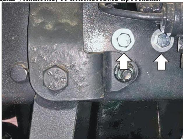
5. Прикрепить задние кронштейны к задним верхним при помощи болтов М12х40 с шайбами 12 и гайками М12.
