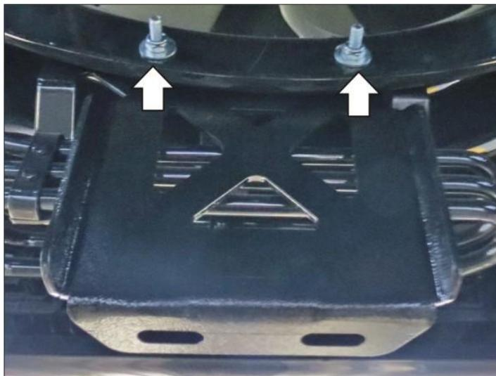
4. Прикрепить щит к кронштейнам при помощи болтов М14х40 с шайбами 14 и гайками М14.
