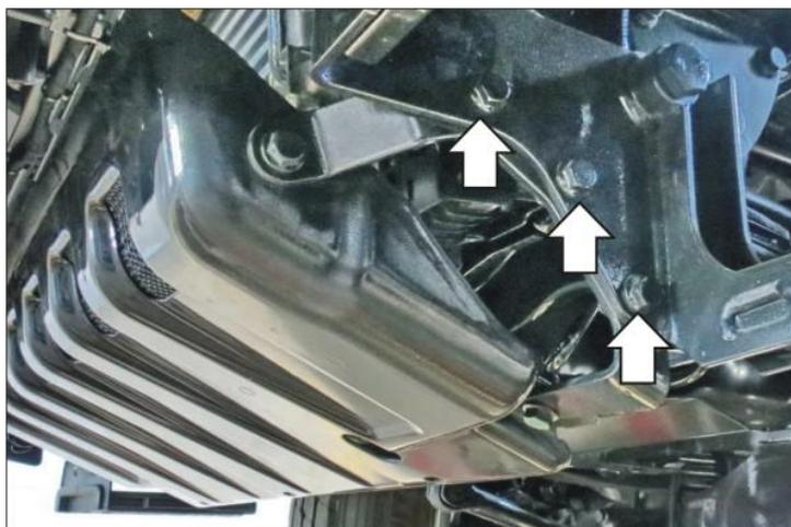
3. Отвернуть штатные болты крепления змеевика компрессора и в эти отверстия установить задний кронштейн при помощи болтов М10х40 с шайбами 10 и гайками М10. Кронштейн устанавливается между поперечиной рамы и кронштейном змеевика. После затяжки болтов проконтролировать расположение трубок змеевика.
